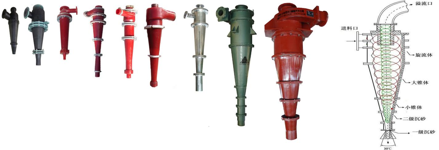
**浓缩、分级旋流器组：**耐磨浓缩，分级水力旋流器组广泛用于矿物质浮选前的分级浓缩和粗煤泥的回收，将矿浆按粒度大小进行分级，也可用于脱泥、浓缩、脱水作业。浓缩分级旋流器组是将多个相同规格的旋流器组合在一起，通过中心分配器将物料均匀分配到每个旋流器中，使每个旋流器能在相同的压力下运转。溢流和底流分别汇集到内外两个收集槽中，由管路排出。旋流器可组合使用，在实际生产中根据液流量大小通过阀门控制调节使用，因此能灵活地调节工作量，可用于各类选煤厂可提高矿浆的浓度，提高精矿的回收率。
