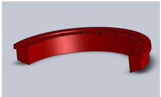
3、胶圈内口为外大里小的方式，减小介质流动对胶圈产生的阻力，进一步减小了胶圈的磨损，大大提高了胶圈使用寿命。
